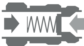
Zpětný tok - pojistka uzavřena
