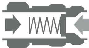
Rückströmung - Ventil schließt
